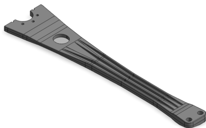
Fig. 2. Baseline flexbeam
