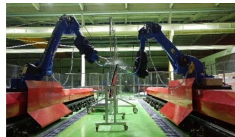
Fig. 13. NDT Test(C-Scan)
