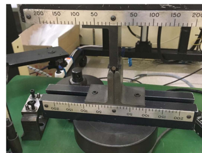
Fig. 9. ILSS Test Setup
