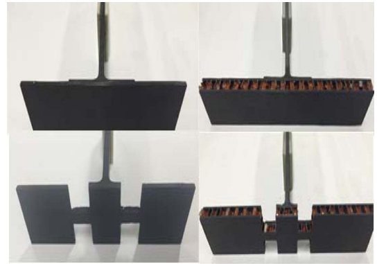
Fig. 2. Composite T-joint & cut out T-joint
